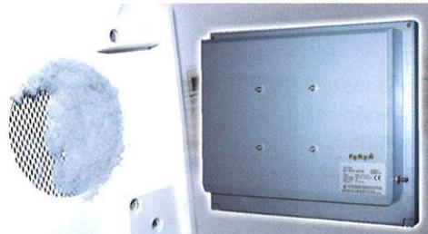
Pour l'utilisation d'ordinateurs médicaux optimisés en milieu clinique : grâce au refroidissement passif, le ventilateur et les fentes de ventilation sont inutiles. Le boîtier est complètement fermé et donc facile à stériliser Photos : Penta
